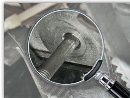
Fig. 2: El espárrago está roscado correctamente.
